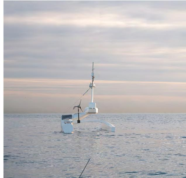
Le Sphyrna 55 (17 mètres) et le Sphyrna 70 (21 mètres) sont les drones de surface utilisés pour cette mission. Conçus et développés par le bureau d'études navales Sea Proven, ils sont autonomes, silencieux, et embarquent plus d'une tonne de matériel, dont des hydrophones.
