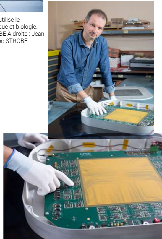
Le détecteur TRADERA développé à l'origine pour la radiothérapie conventionnelle, est actuellement valorisé pour d'autres besoins industriels Yannick ARNOUD, enseignant-chercheur à l'Université Grenoble Alpes, Physicien au laboratoire LPSC à Grenoble
