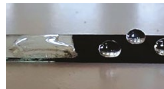
Gouttes d'eau sur du verre (à gauche) / sur une couche de charbon (à droite). © Maëlys Daubias
