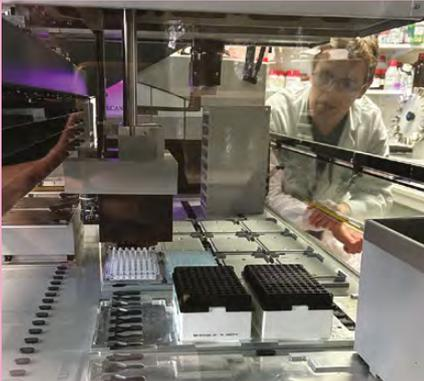
Dans les laboratoires du CRCL, cet automate de pipetage manipule des échantillons biologiques en transférant de petites quantités de liquide avec précision. Il permet de traiter rapidement un grand nombre d'échantillons tout en réduisant les erreurs, ce qui libère du temps aux chercheurs pour analyser les données.
